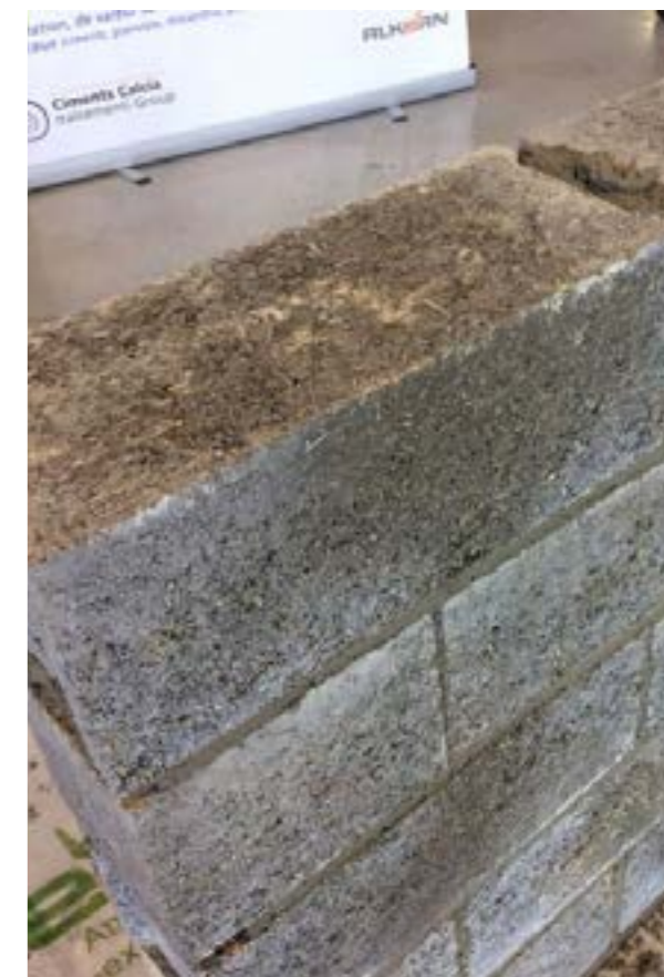
betonblokken gemaakt van Miscanthus vezels, water, cement, grind en zand.
