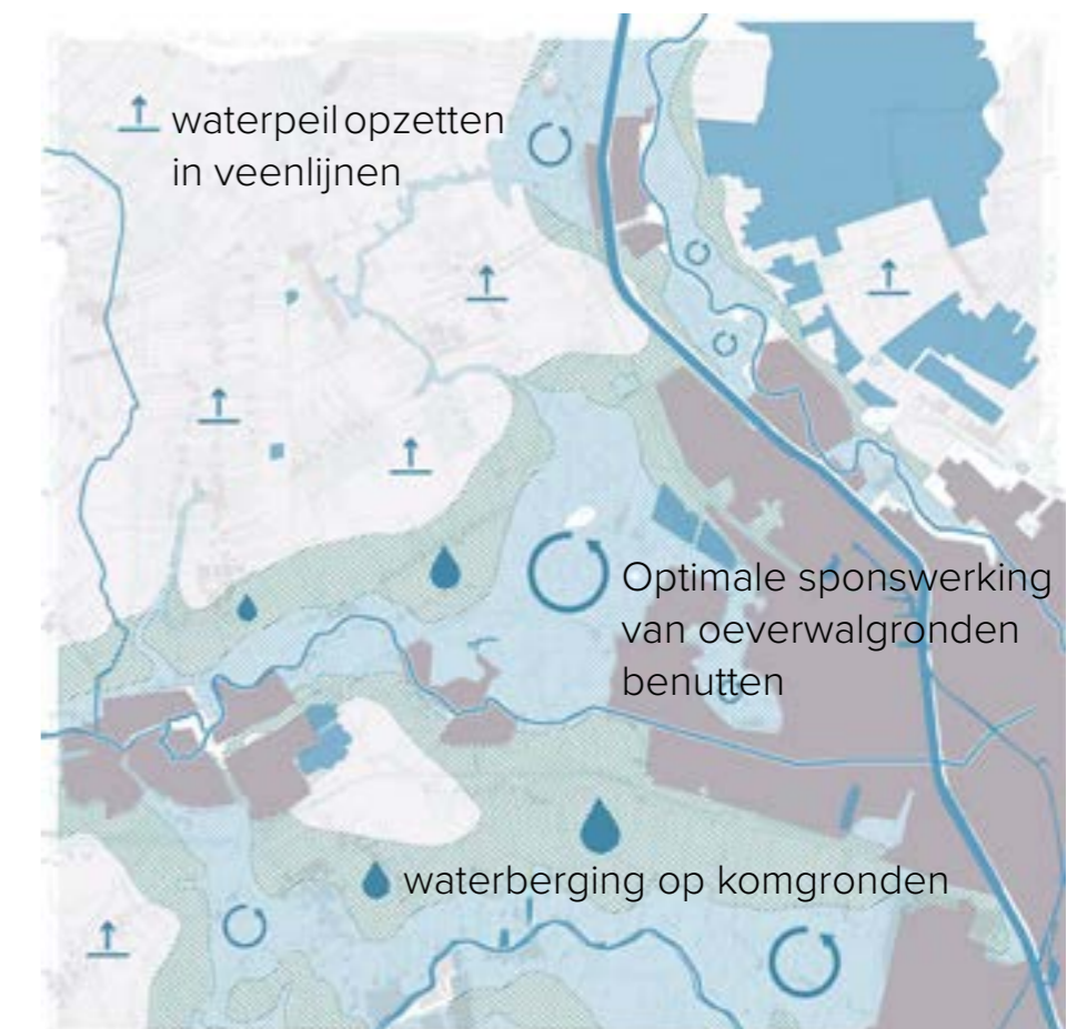
Door in periodes van neerslag het waterpeil op te zetten op de komgronden, kan water in de ondergrond worden geborgen. In periodes van droogte kan het waterpeil tot de kleigrens worden verlaagd, en kan het water in het veengebied worden ingelaten. Zo wordt de oxidatie van veen in periodes van droogte geremd.
